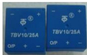
TBV5、10/25A 系列电压传感器的初、次级之间是绝缘的，可用于测量直流、交流和脉冲电压。
